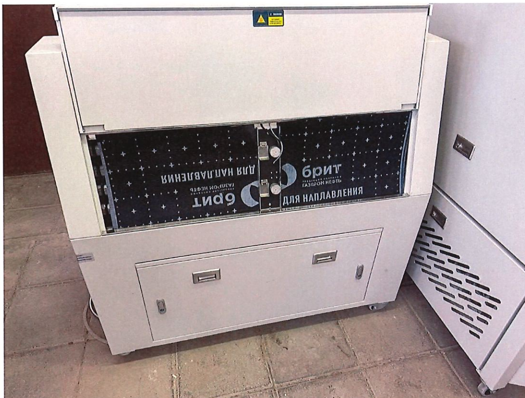
Рисунок 1 – Проведение ультрафиолетового облучения образцов.
