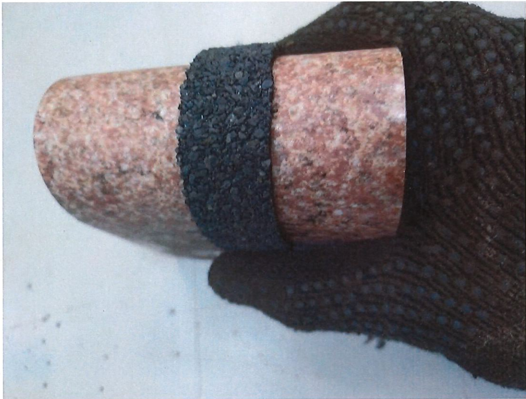
Рисунок 7 – Определение гибкости образца на брус.
