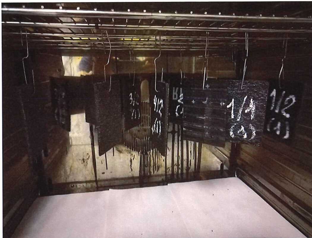
Рисунок 5 – Проведение термостатирования образцов для определения теплостойкости.
