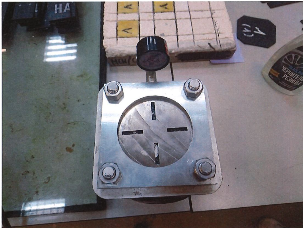
Рисунок 8 – Проведение испытаний образцов на водонепроницаемость.
