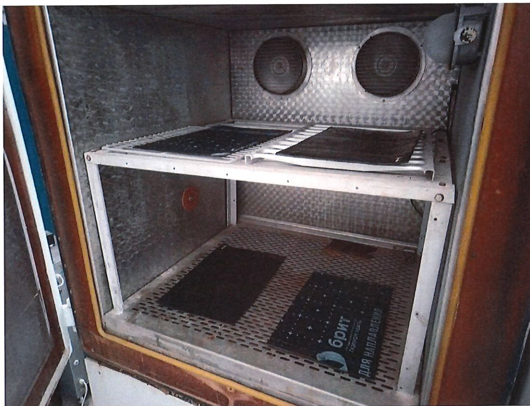
Рисунок 3 – Проведение замораживания образцов при температуре минус 20 °С.
