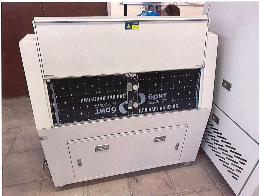
Рисунок 1 – Проведение ультрафиолетового облучения образцов.
