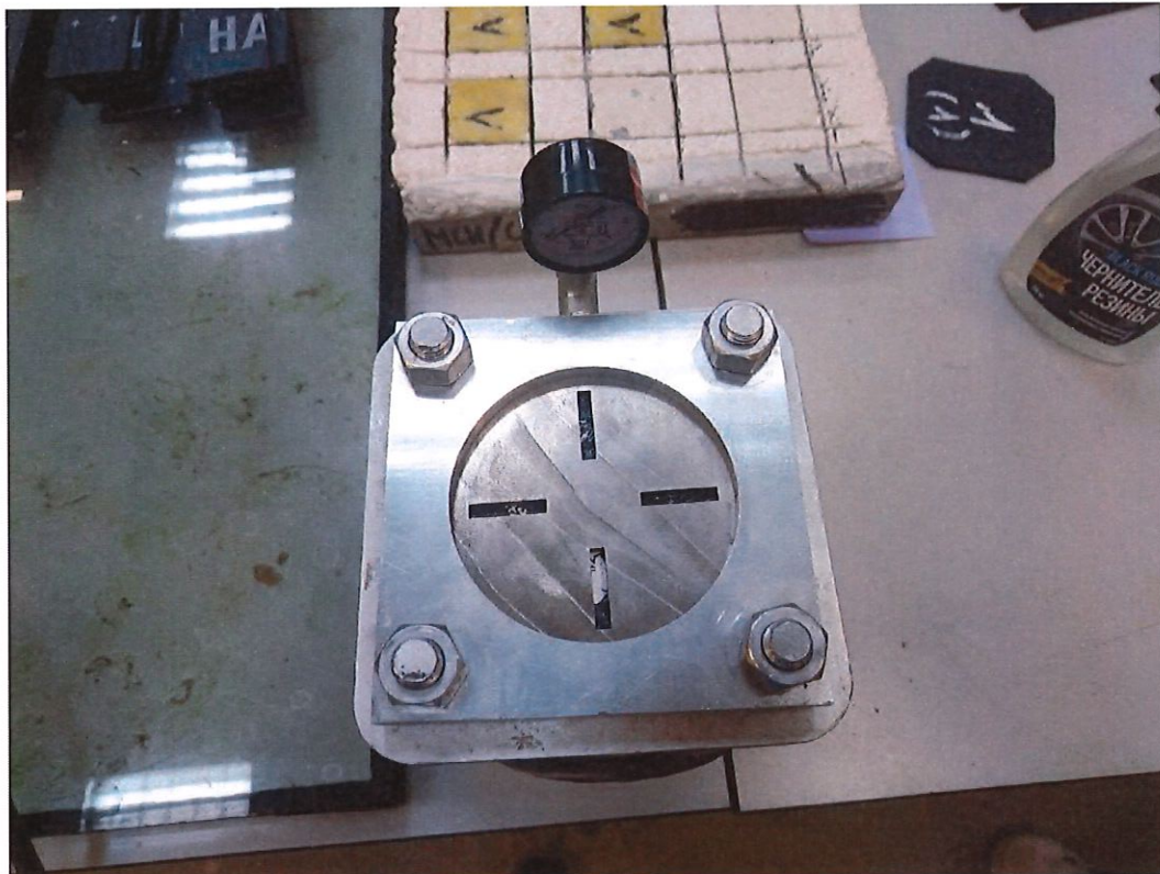
Рисунок 8 – Проведение испытаний образцов на водонепроницаемость.
