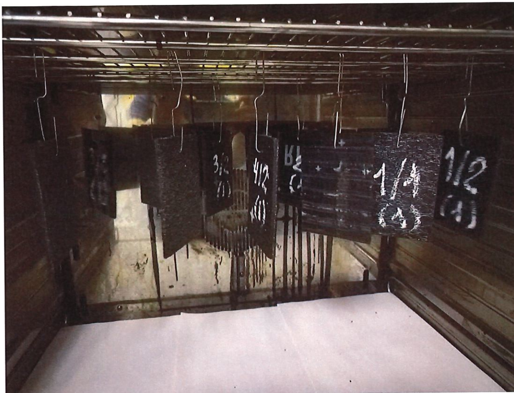
Рисунок 5 – Проведение термостатирования образцов для определения теплостойкости.
