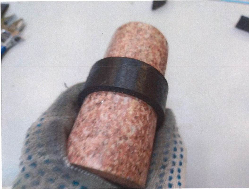
Рисунок 7 – Определение гибкости образца на брус.
