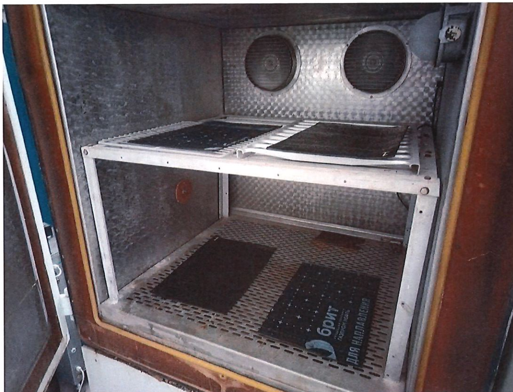
Рисунок 3 – Проведение замораживания образцов при температуре минус 20 °С.
