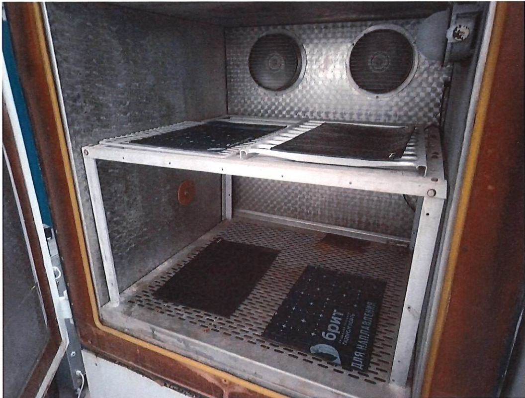
Рисунок 3 – Проведение замораживания образцов при температуре минус 20 °С.
