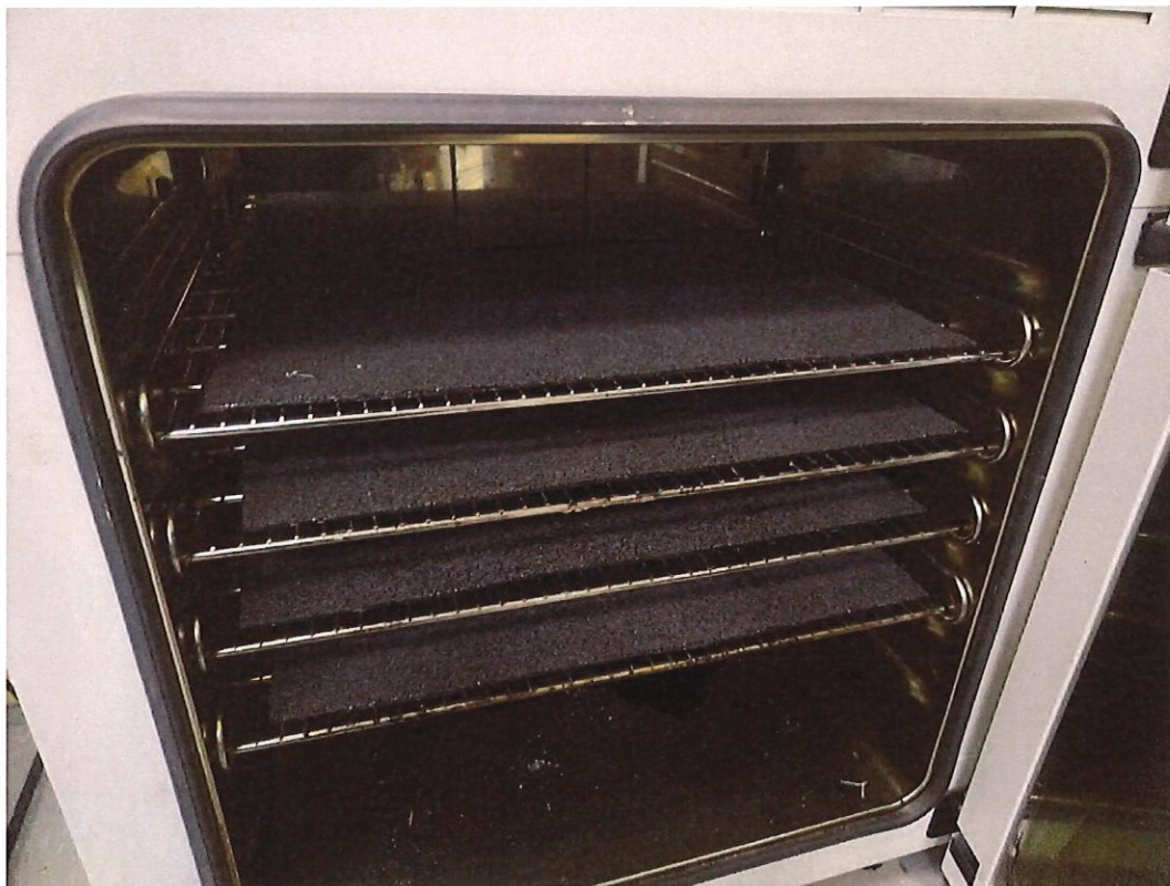
Рисунок 4 – Проведение теплового воздействия на образцы при температуре 80 °С.
