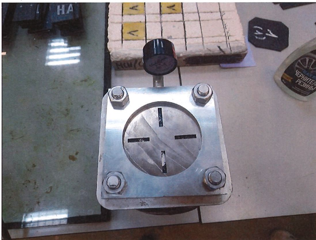
Рисунок 8 – Проведение испытаний образцов на водонепроницаемость.
