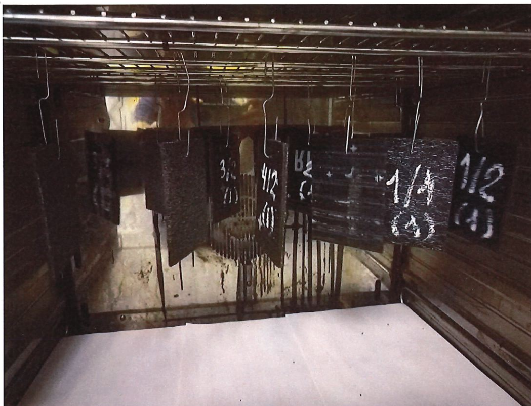
Рисунок 5 – Проведение термостатирования образцов для определения теплостойкости.
