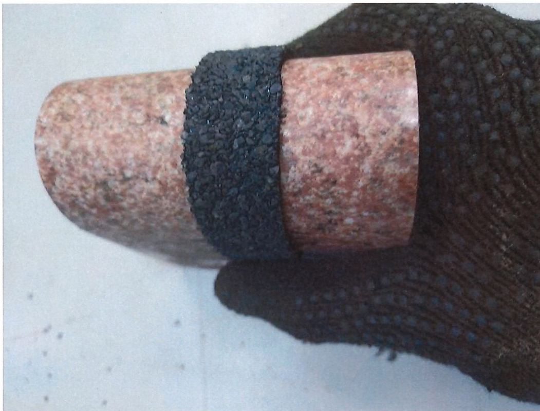
Рисунок 7 – Определение гибкости образца на брус.
