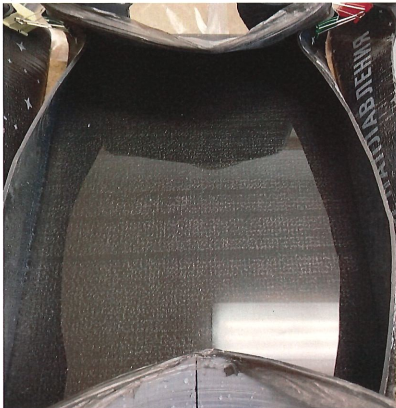
Рисунок 3 – Выдержка образца материала в насыщенном растворе NaCl 15%
