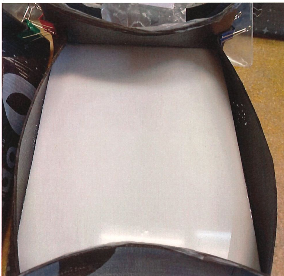
Рисунок 2 – Выдержка образца материала в известковом молоке.
