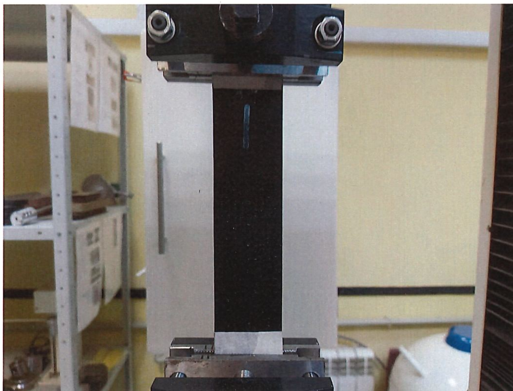
Рисунок 4 – Проведение испытания образца на растяжение
