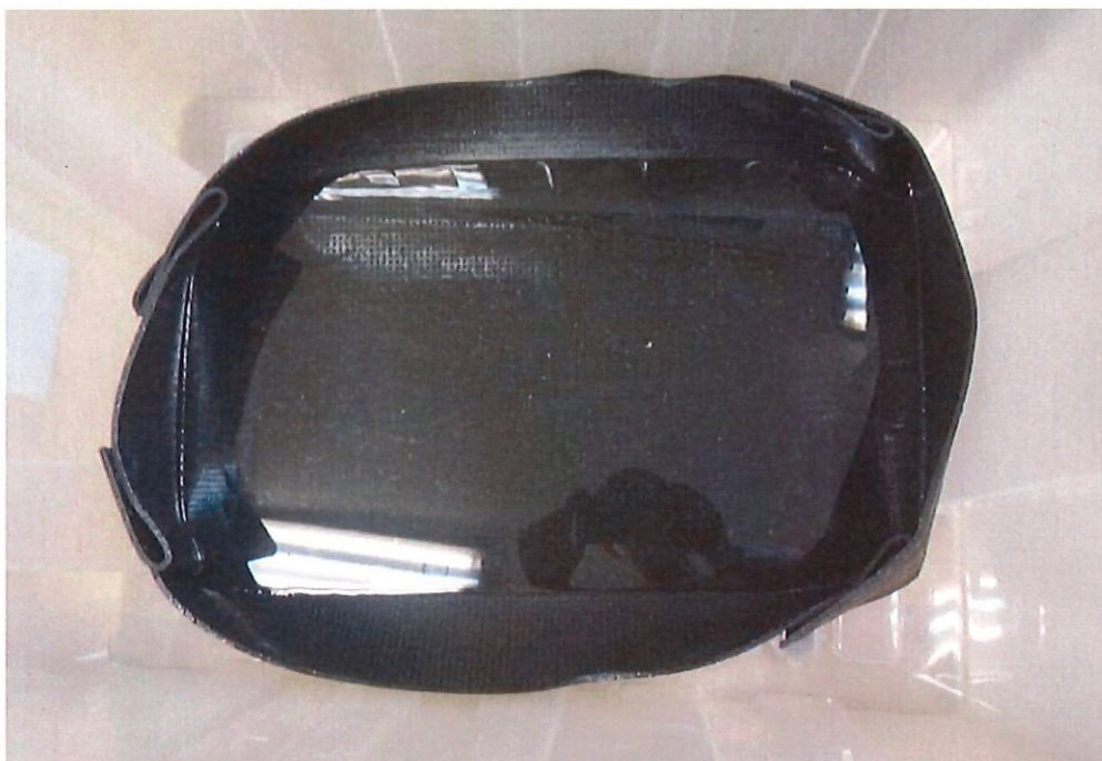
Рисунок 1 – Выдержка образца материала в соляной кислоте (HCl) 14%
