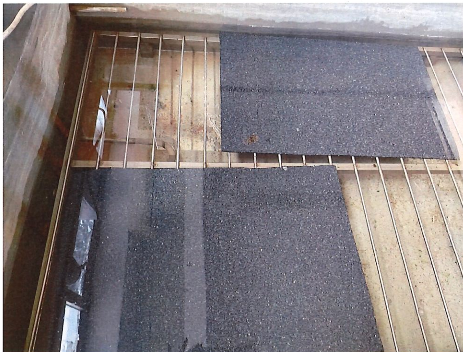
Рисунок 2 – Проведение замачивания образцов в воде при температуре (20 \pm 2)^\circ\text{C} .
