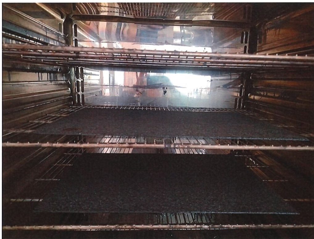
Рисунок 4 – Проведение теплового воздействия на образцы при температуре 80 °С.
