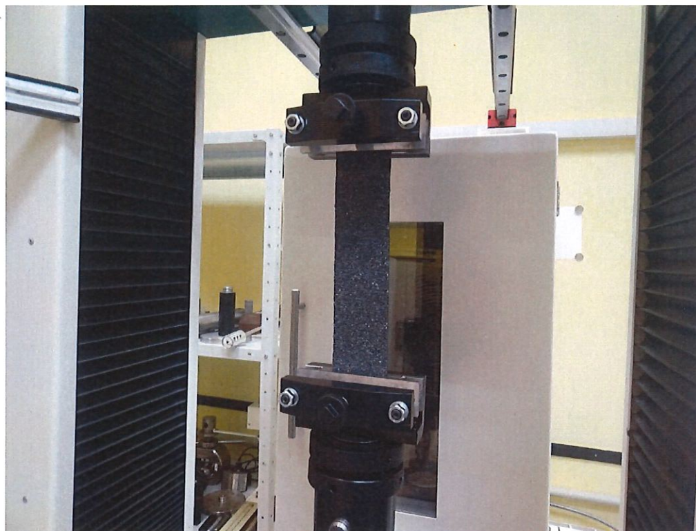
Рисунок 7 – Проведение испытаний по определению прочности и деформативности образцов
