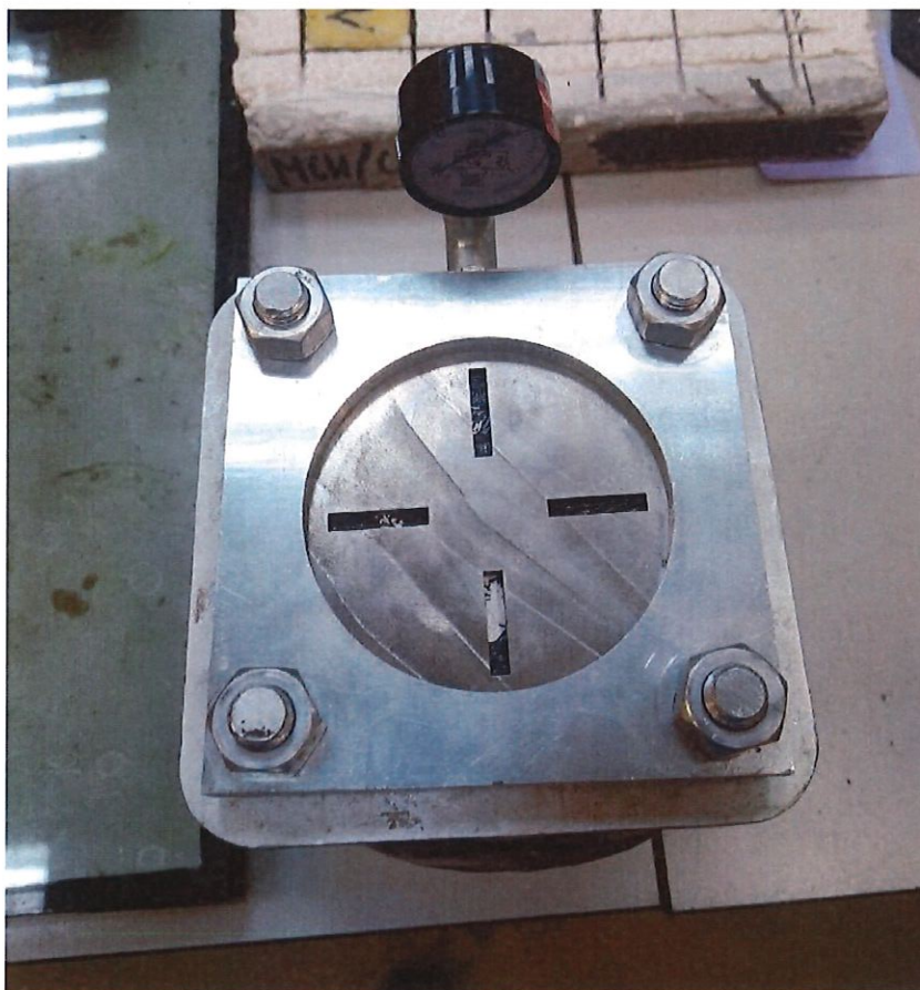
Рисунок 8 – Проведение испытаний образцов на водонепроницаемость.
