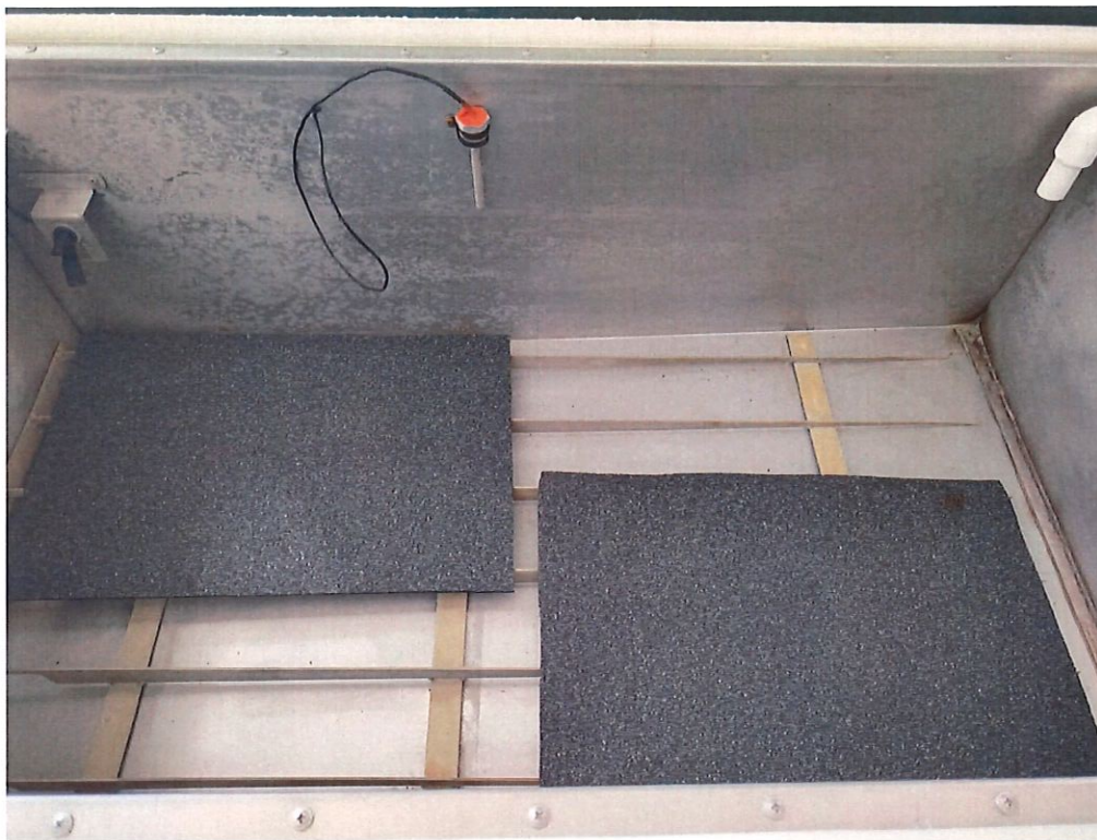
Рисунок 3 – Проведение замораживания образцов при температуре минус 20 °С.
