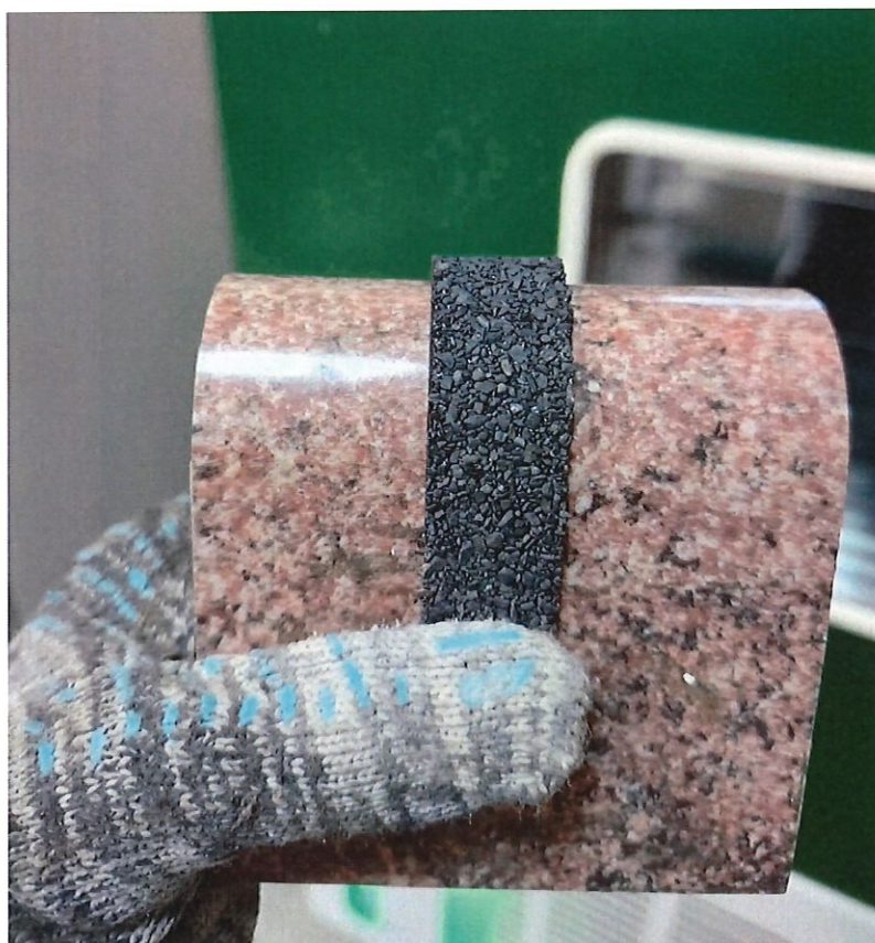
Рисунок 6 –. Определение гибкости образца на брус
